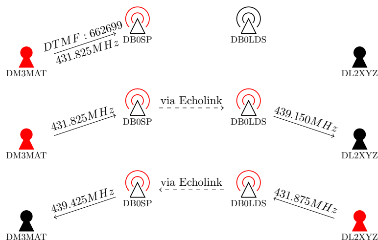
Abbildung 3: Repeaterbetrieb mit Echolink. DM3MAT verbindet die Repeater DB0SP (bei Berlin) und DB0LEI (bei Leipzig) per Echolink. Daraufhin können DM3MAT und DL2XYZ wie über einen gemeinsamen Repeater kommunizieren.
