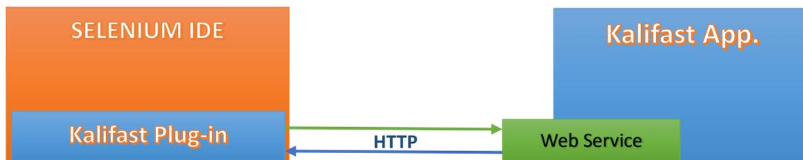
Le schéma ci-dessous traduit l'architecture du plug-in mais également son existence vis-à-vis de Sélénium IDE. Effectivement, il apparaît comme une surcharge du plugin et interagit avec la solution Kalifast par le biais de l'Ajax et de requêtes http.
